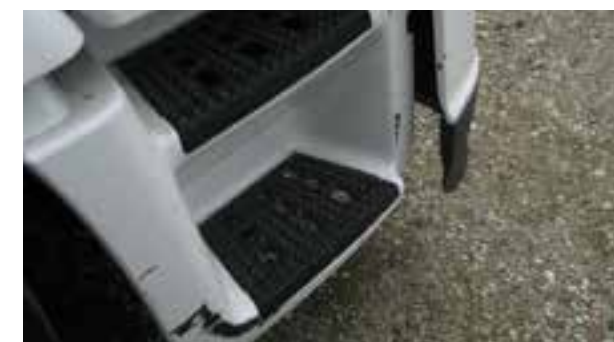
Отстранен материал, счупена част
