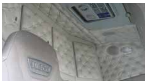
Леко обезцветяване, дължащо се на слънчевата светлина
