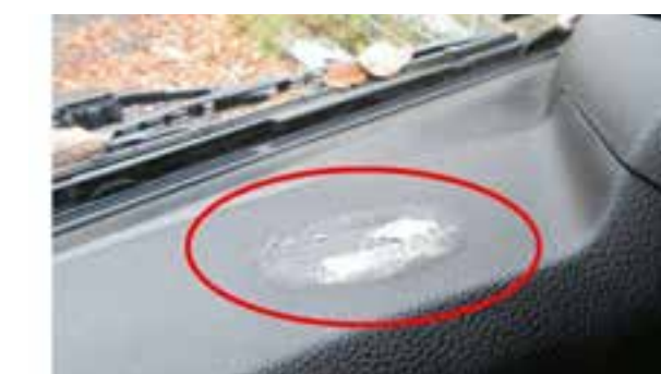
Текстилни и пластмасови облицовки: Скъсване, пробиване > 5 mm, неотстраними белези
