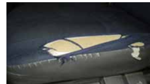
Изгаряне с размер > 3 mm, перфориране или скъсване на покритието без увреждане на пяната
