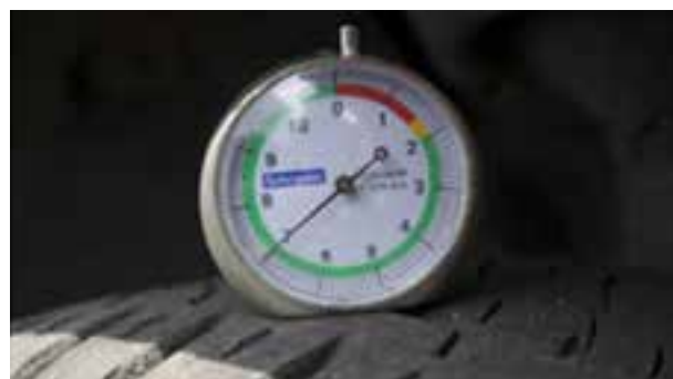
Гуми: Дълбочина на протектора \geq 7 mm (СЪОТВЕТСТВА) Забележка: Дълбочината на протектора се измерва в най-износения канал на гумата.
