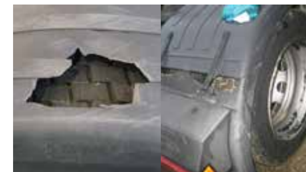
Отстранен материал, счупена част
