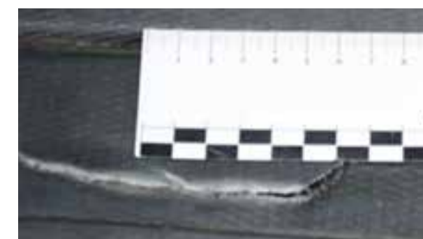
Перфориране на твърд пластмасов облицовъчен елемент. Ремонтът на твърди пластмасови облицовъчни елементи се извършва за 1 час по фиксирана тарифа, ако е възможен и приемлив от естетична гледна точка
