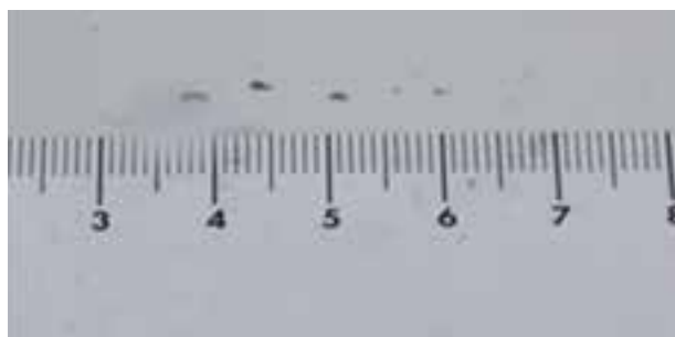
Нащърбване с диаметър \leq 5 mm и \leq 20 нащърбвания
