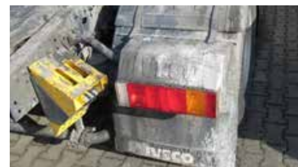
Значително обезцветяване в резултат от химично въздействие
