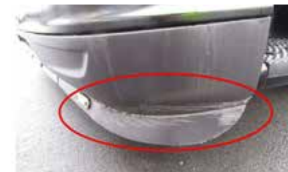
Отстранен материал или деформиране, което е възможно и икономически изгодно да се ремонтира
