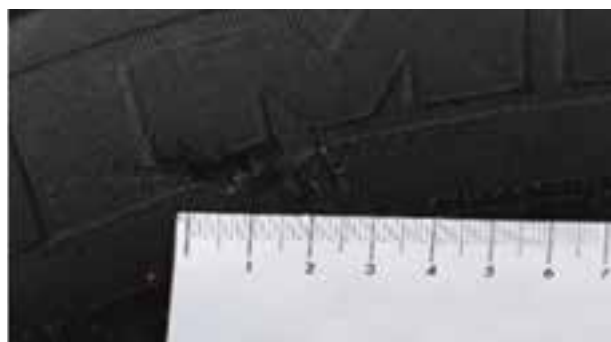
Гуми: Прорез с дълбочина \leq 3 mm (ДОПУСКА СЕ)
