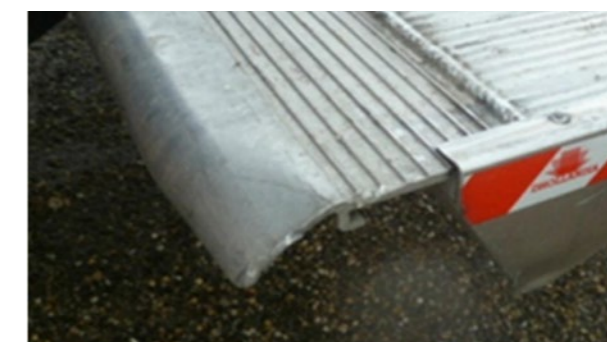
Задна подемна платформа: Деформации на платформата, чийто ремонт е икономически изгоден
