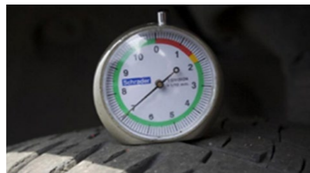
Гуми: Дълбочина на протектора \geq 5 mm (СЪОТВЕТСТВА) Забележка: Дълбочината на протектора се измерва в най-износения канал на гумата.
