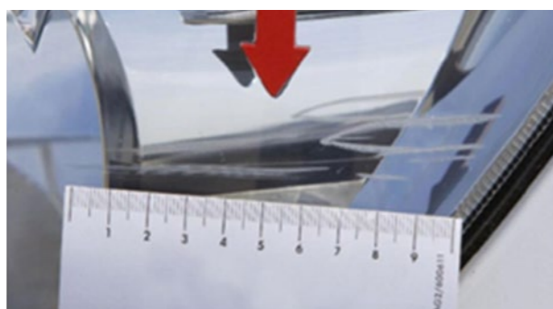
Дълбоки драскотини (с отстраняване на материал) извън осветяваното поле при херметични фарове
