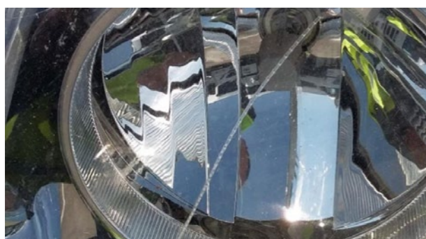
Драскотина в осветяваното поле, пукнатина, кондензация, счупване или счупен закрепващ елемент
