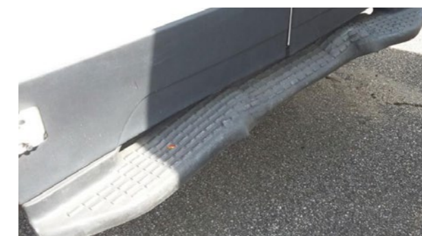
Задно стъпало: Деформации, чийто ремонт не е икономически изгоден
