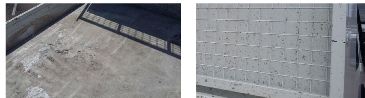
🔧 Следи от бетон или химични вещества върху \geq 1/4 от повърхността на каросерията на самосвала
