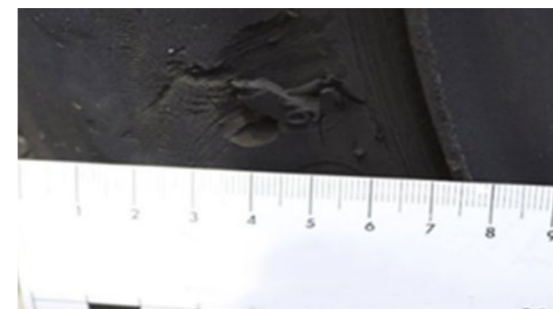
Гуми: Прорез с дълбочина > 3 mm, отстраняване
