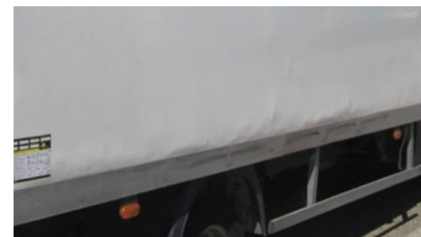
Странични панели със стъкловакна: деформиране на долната част на дължина > 1 m ЗАБЕЛЕЖКА: За смяна на предния панел трябва да се разглоби долната част на каросерията.
