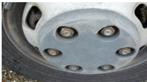
Джанти и тасове на колелата: Многобройни повърхностни драскотини с или без отстраняване на материал
