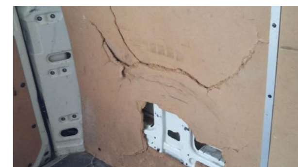
Вътрешни дървени предпазни елементи: Следи от удари, скъсани панели, липсващи панели (с изключение на горните панели на вратите)
