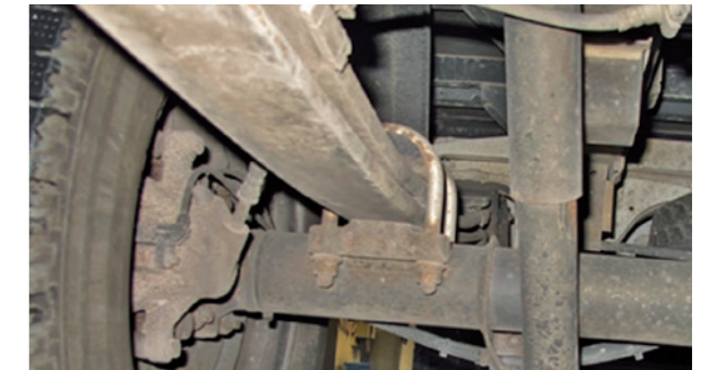
Течове от кормилната кутия и помпата на усилвателя на кормилното управление
