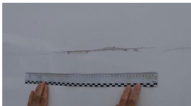
Странични панели: драскотини с отнемане на материал и размер \geq 20 cm, чийто ремонт е икономически изгоден. Опция за боядисване на половин панел
