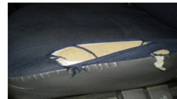
Изгаряне с размер > 3 mm, перфориране или скъсване на покритието без увреждане на пяната
